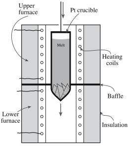
FIGURE 29.8 The Bridgman-Stockbarger technique.
